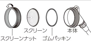
\*ヘッド部から水漏れが発生した場合は、一度本体から図の順序で部品を取りはずし、再度取り付けなおしてください。
