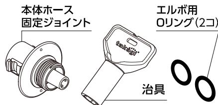
**C 通水エルボセット**
