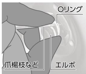
① Oリングを親指と人指し指で浮かせ、爪楊枝などを隙間に差し込む。
