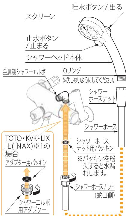
**△注意** 使用後は必ず吐水状態にし、混合栓のハンドルで止水してください。
